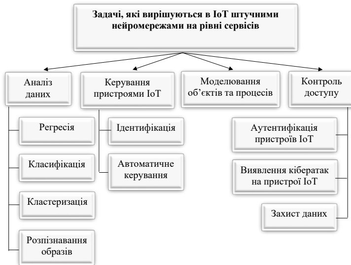
Рис. 2. Схема класифікації завдань, які вирішуються на базі штучних неймереж, в IoT на рівні сервісів
